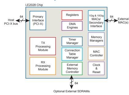
TCP/IP Offload Engine LE2028™
